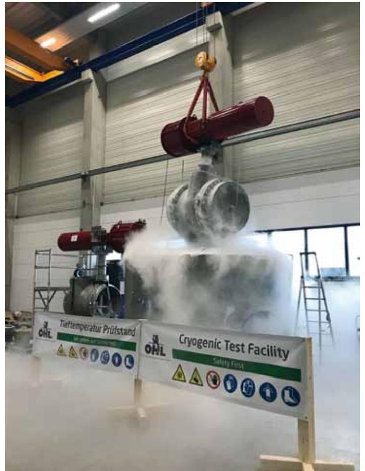
Die kryogenen Prüfverfahren durchlaufen verschiedene Schritte. OHL Gutermuth setzt dabei auf höchste Anforderungen an Dichtheit und Betriebssicherheit bei extremen Temperaturen.
