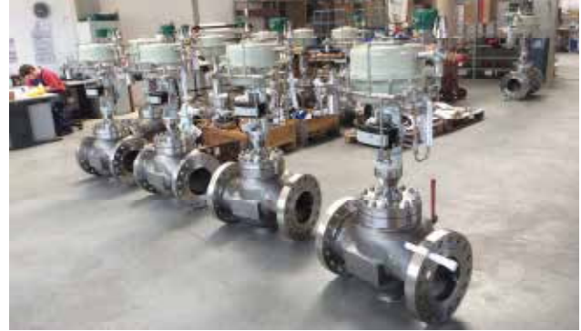
Pruss hat Stellventile für die Nutzung mit hundert Prozent Wasserstoff entwickelt.
