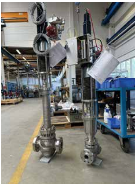
Die Wasserstoff-Regelarmaturen von Pruss erfüllen die extremen Dichtheitsanforderungen von Wasserstoffanwendungen.
