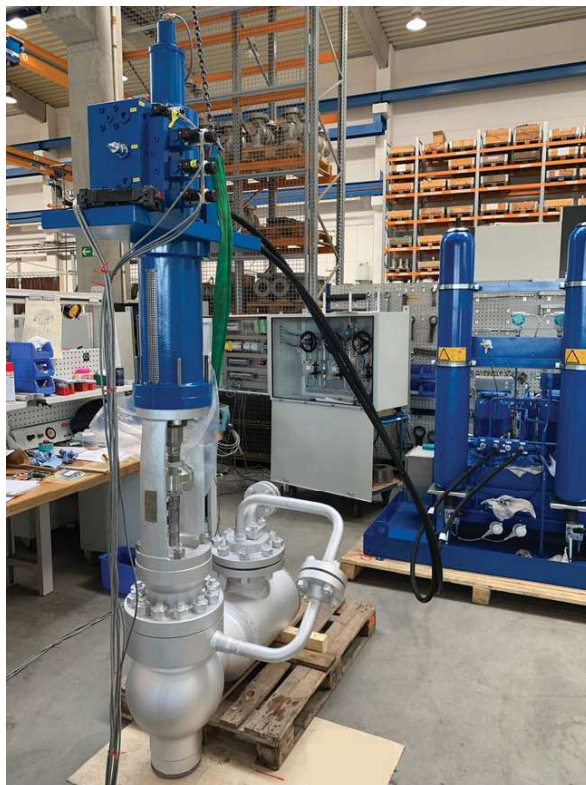
Hydraulisch angetriebene HDU mit nachgeschaltetem Treibdampfkühler, Hydraulikstation und bauteilgeprüfem Dampfprüfstock aus eigener Entwicklung und Produktion.
