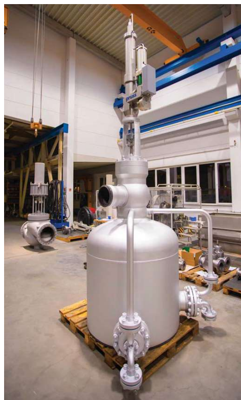
Turbinenbypass Station mit autarkem Elektrohydraulischem Stellantrieb PEHD.
