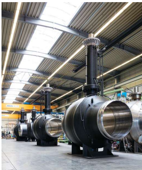
Erdeinbauhähne für Gas in der Nennweite DN1200
