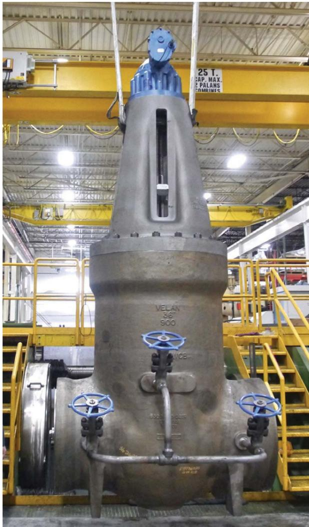
Eines von Velans parallelen Schiebventile (23", PN 50) für den Betreiber einer dampfgestützten Schwerkraftentwässerungsanlage im Westen Kanadas – das größte Ventil seiner Art, das je nach Alberta geliefert wurde
