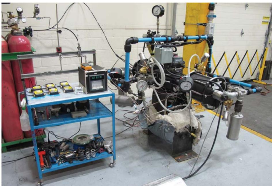
Eigenes Qualifizierungsverfahren eines Prototyps einer schnelllaufenden, Hochtemperaturarmatur von Velan (4", PN 150/250, + 100k Takte)
