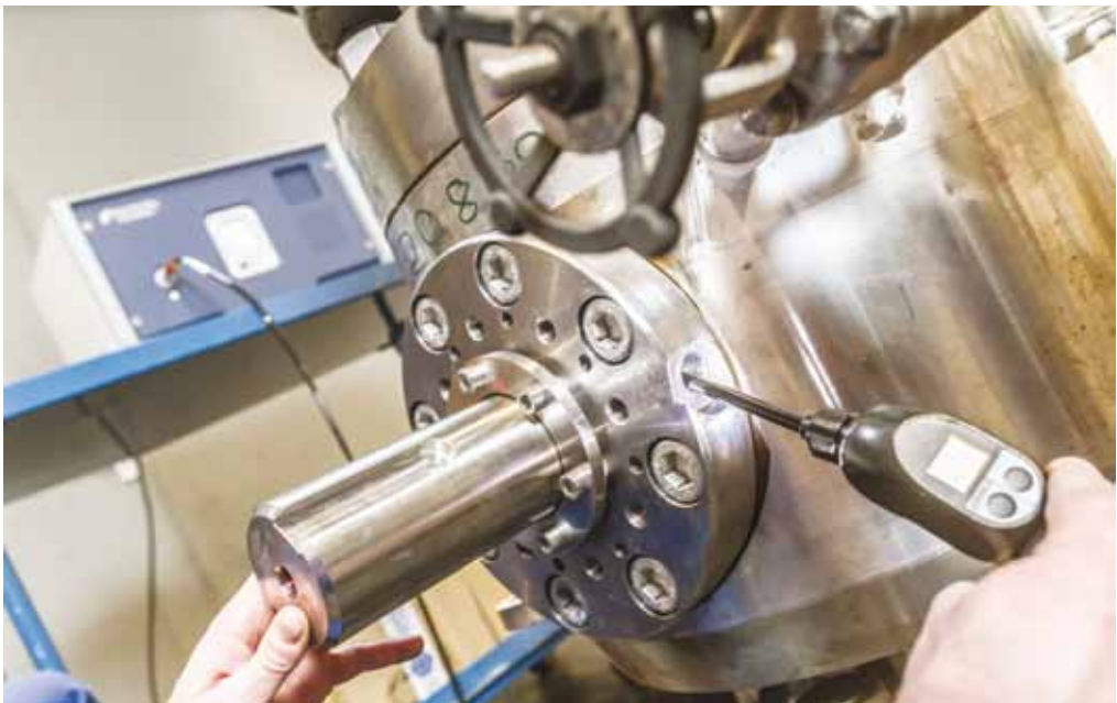
Zukunftssicher mit Wasserstoff: Die fachgerechten Dichtheitstests und Materialeignungsprüfungen bietet Hartmann Valves sowohl für eigene Armaturen als auch für Produkte anderer Hersteller an.
